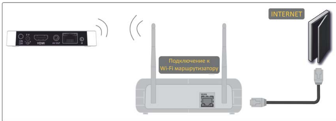
Рисунок 11 – Подключение к сети провайдера, используя Wi-Fi маршрутизатор
