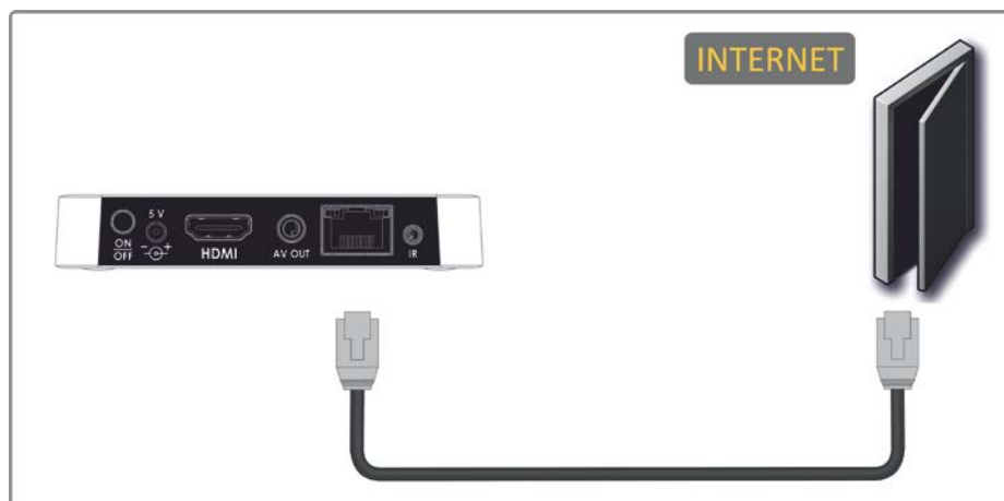
Рисунок 9 – Подключение к сети провайдера без домашнего маршрутизатора
