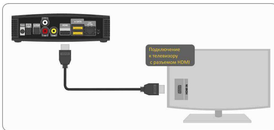
Рисунок 7 – Подключение к телевизору по интерфейсу HDMI
